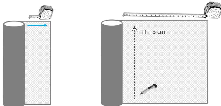
**Bahn aufrollen: Rolle** die Bahn auf, sodass das Glasvlies außen liegt.
